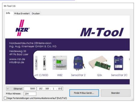
Hier lassen sich direkt IP und Port unseres Gerätes eintragen. Wenn man nun so nach einem Zähler sucht, wird dieses logisch vom PC durchgeführt, für die Physik sorgt unser Gerät quasi wie ein Pegelwandler.
