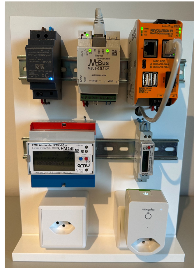
Demo: MBUS-GSLE125 mit PLC Kunbus, 2x EMU und myStrom
