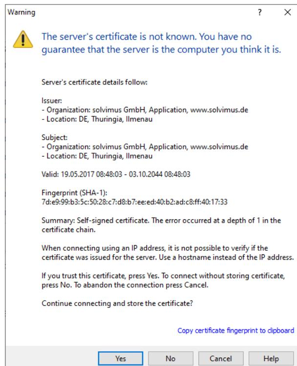
Abbildung 8: Sicherheitsabfrage zum Zertifikat des Geräts für FTP-Zugriff
