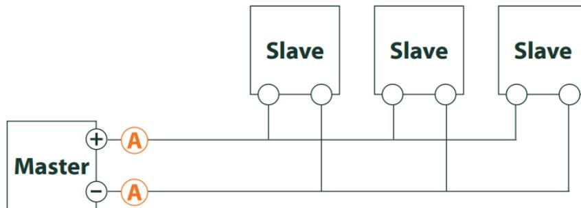
Abbildung 33: Fehlersuche beim M-Bus durch Messung mit Multimeter
