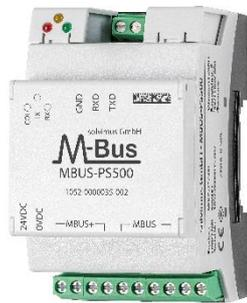
Auch hier gilt: es ist keine gesonderte Konfiguration notwendig. Der Installationsaufwand ist dadurch gering.
