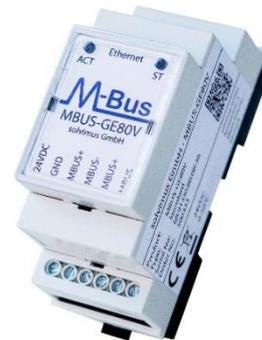
Unsere MBUS-GE20V und MBUS-GE80V sind zwei Pegelwandler, welche die Daten von bis zu 20 bzw. 80 Zählern als Ethernet-Datenpakete transparent zur Verfügung stellen. Die Gegenstelle kann direkt vor Ort, aber auch weit entfernt sein. Ein einfacher TCP-Socket (oder optional ein virtueller COM-Port; wir empfehlen den Treiber der Firma Eltima) wird auf dem Endgerät genutzt, um über Ethernet auf dem M-Bus zu kommunizieren.
