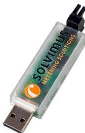
Speziell für den Service-Einsatz und für die temporäre Auslesung ist unser Pegelwandler MBUS-PU3 geeignet. Dieser setzt von USB auf M-Bus um und ermöglicht so die direkte Kommunikation zwischen Zähler und mobilen Geräten wie Laptop oder Smartphone. Die Versorgung erfolgt dabei einzig über den USB-Port. Der MBUS-PU3 verfügt über Status-LEDs zur Anzeige des Betriebszustands.
